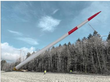
Gerüstet für die Zukunft. SCHEUERLE BladeLifter auch für die längsten Rotorblätter geeignet.
