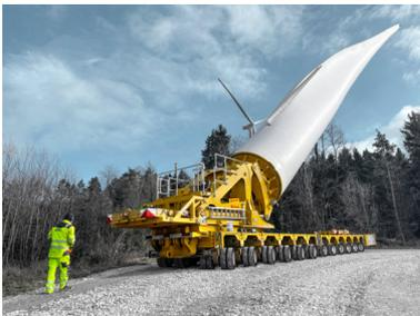
84 Meter misst dieses Rotorblatt. Der Aufstellwinkel von 60° sorgt für maximale Manövrierfähigkeit.
