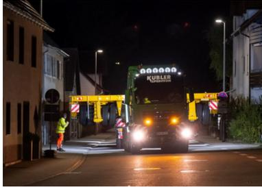
Robuste Achslinien: 18 Achslinien SCHEUERLE InterCombi unterstützen den erfolgreichen Transport. Insgesamt 250 Tonnen Gesamtgewicht und 40 Meter Gesamtlänge misst jeder der 2 Konvois. Engstellen meistert Kübler mit Bravour.
