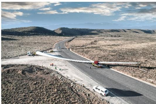
SCHEUERLE RBTS (RotorBlattTransportSystem) mit 83 Meter langem Rotorblatt.
