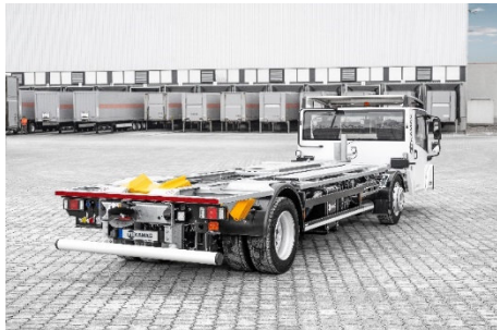
Der feuerverzinkte Rahmen, Hubtisch und Kabinenlagerung verleiht dem KAMAG PM einen zuverlässigen Korrosionsschutz.
